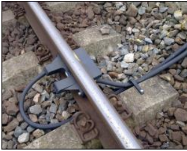
Afbeelding 20. AZ LM ACE (Axle Counter Evaluator)
